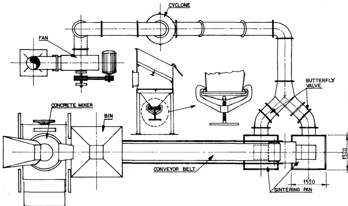
FIG. 02 - LAYOUT FOR SEMI-INDUSTRIAL
